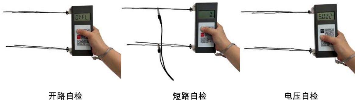
首先安装定位好两根 V 型测量杆，滑动仪器顶部电源开关到 ON 处，电源接通，液晶屏显示“0000”，再将两根测量杆分别接触被测绝缘子两端金具部分，使之接触良好，然后按下【电阻 MΩ】键，液晶屏即显示被测的绝缘子的绝缘电阻值；若显示屏出现“0MΩ”或“低于 300MΩ”时，并发出蜂鸣音，则说明该片绝缘子已经短路或劣化低值。显示若为“OVFL”，则说明所测绝缘子电阻值大于 1999 MΩ。当测量杆与绝缘子金具接触不好，仪器两端开路，也会显示“OVFL”。
